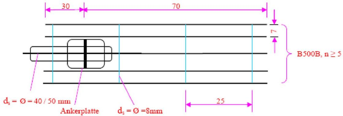
**Bild 5. Beispiel für die Bewehrung einer Stütze**
